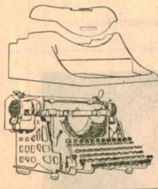
La prima macchina per scrivere da ufficio con carrello monoguida e con carrozzeria amovibile su telaio a struttura reticolare. Il cinematico ad accelerazione progressiva assicura un tocco leggerissimo e consente di ottenere la massima velocità di scrittura con la minima fatica. Può essere fornita con incolonnatore o con tabulatore decimale.
